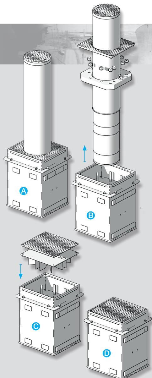
La structure de la borne ONE50<sup>EVO</sup> est basée sur la version escamotable, sans le mécanisme hydraulique, ce qui lui confère une résistance à l'impact aussi importante qu'une borne automatique.
