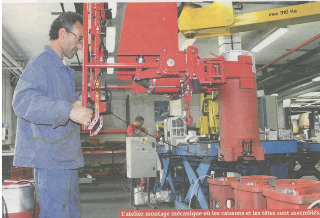
L'atelier montage mécanique où les caissons et les têtes sont assemblés.
